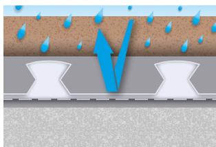
Lo strato continuo in HDPE garantisce immediatamente la tenuta idraulica.
