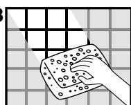
Espera al menos 90 minutos a 21°C (70°F) para el lavado final y siga el mismo procedimiento del lavado inicial. Agregue 7.6 l (2 galones) de agua limpia al aditivo de limpieza para lavado final y mezcle hasta que se disuelva por completo. En el lavado final, evite el contacto con el rejunte y límpie sólo la superficie del revestimiento.
