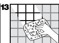
Attendre au moins 90 minutes à 21 °C (70 °F) avant de procéder au lavage final en suivant la même procédure que pour le lavage initial. Préparer 7,5 litres (2 gallons) d'eau propre, ajouter l'additif nettoyant pour lavage final et mélanger jusqu'à la dissolution complète. Lors du lavage final, éviter le contact avec le coulis – nettoyer uniquement la surface des carreaux.
