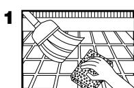
Antes de aplicar el mortero para juntas, extraiga los espaciadores y los residuos de las juntas, y elimine el polvo y la suciedad con una esponja húmeda. No deje agua estancada en las juntas. No use limpiadores ácidos para limpiar el revestimiento. La temperatura del sustrato debe estar entre 7°C (45°F) y 32°C (90°F).
